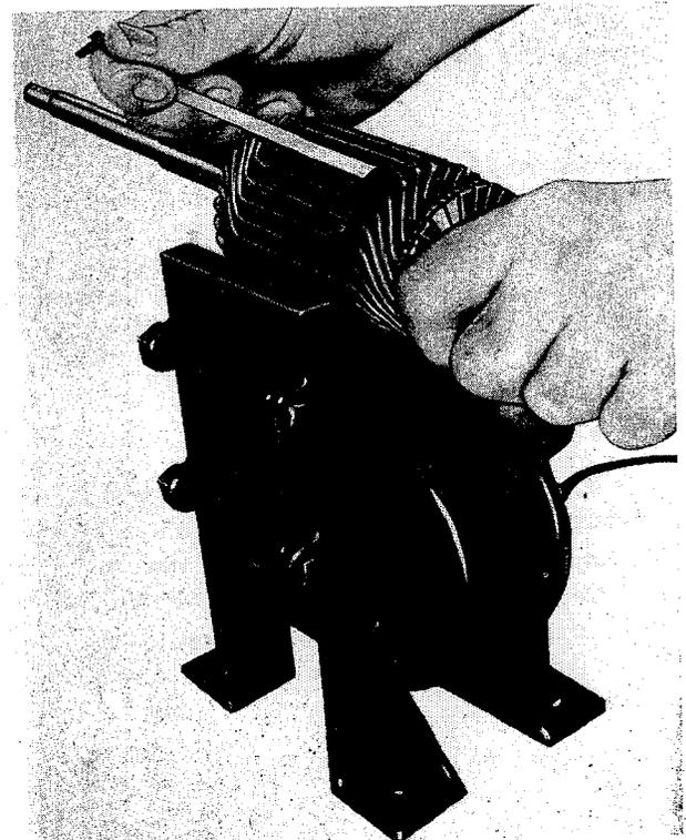
Fig. 123 Induktions-Prüfvorrichtung
