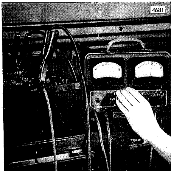
Zellspannung prüfen Contrôle de la tension d'un élément Fig. 53 Measuring the cell voltage
