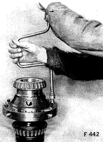
Abb. 442 Lösen der kleinen Inbusschrauben
