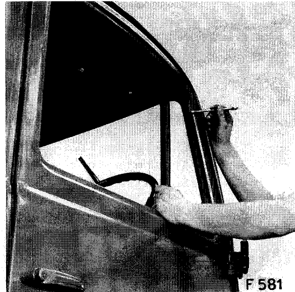
Abb. 581 Lösen der Befestigungsschraube des Flügeltürfensters
