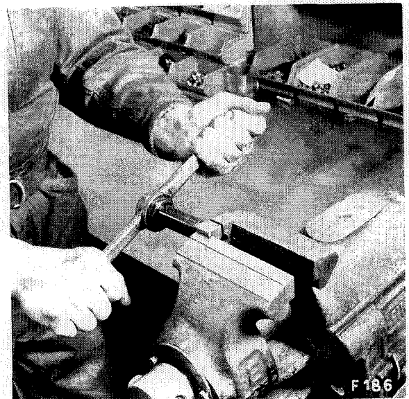
Abb. 186 Ausgewinden des Kolbens aus der Zylinderhülse
