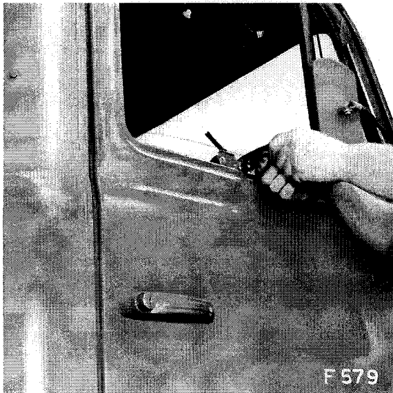
Abb. 579 Lösen der Befestigungsschrauben für den Handgriff am grossen Türfenster
