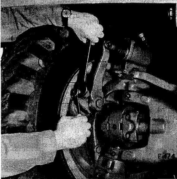
Abb. 474 Nachstellen der Radbremsen vorn 1 Bremshebel 2 Gegenmutter 3 Regulierschraube
