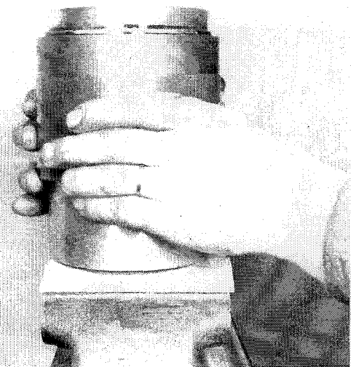
Abb. 78 Aufschieben der Ringmanschette auf den Kolben zum Einpressen der Ringe in die Nuten vor dem Einbau in die Zylinderbüchse
