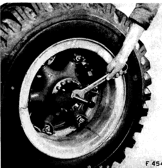
Abb. 454 Aufziehen eines Hinterrades
