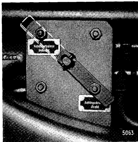
Fig. 78 Robinet de commande du frein de remorque direct ou indirect
