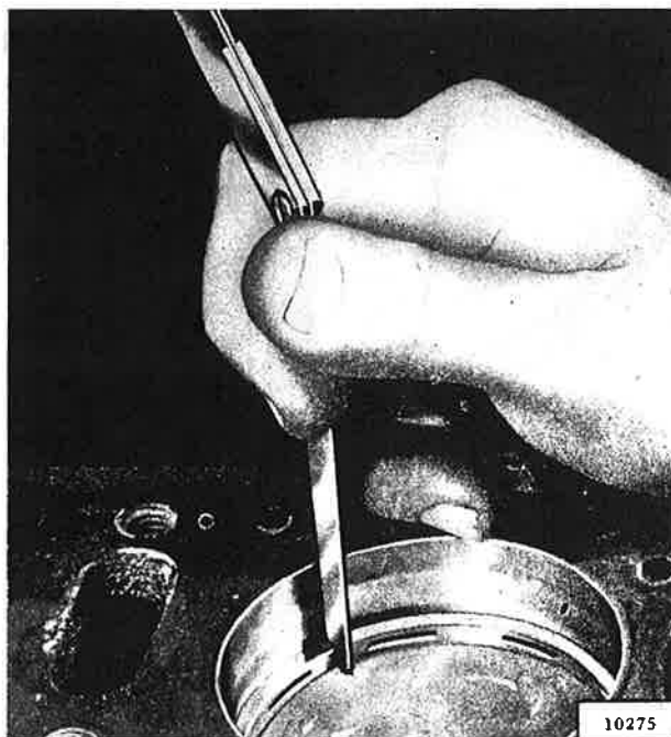
FIG. 41—PISTON RING GAP
