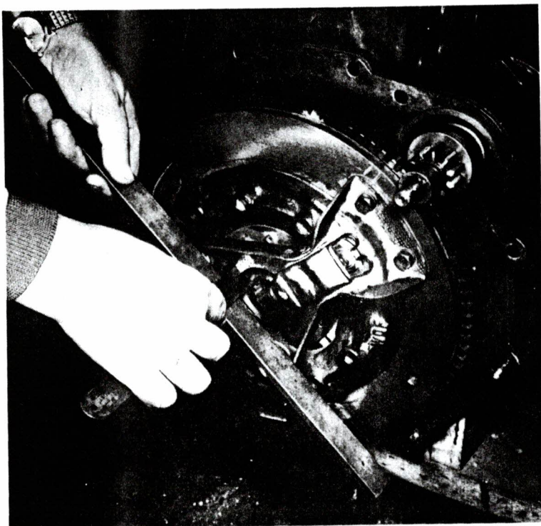
Figure 64. — Réglage des doigts de débrayage
