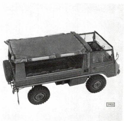
**Abb. 66 Kurzes Verdeck und Plane hinter dem Lastschutzgitter aufgerollt. Großes Verdeck, Verdeckbögen und Verdeckstreben abgenommen.**
