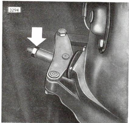
**Abb. 118 Handbremse nachstellen**
